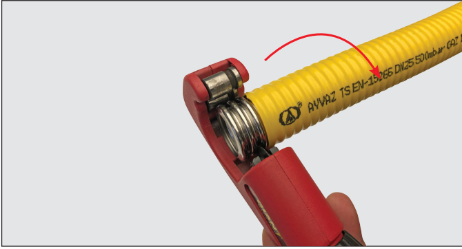
Hortumu kesme aparatına yerleştirme
