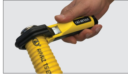
Kaplamanın sıyrıcı yardımıyla sıyırılması
