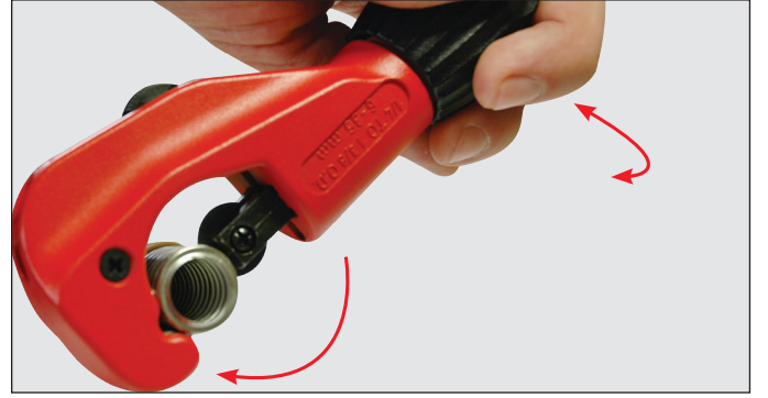
Kesme işlemi için aparatı hortum etrafında döndürme
